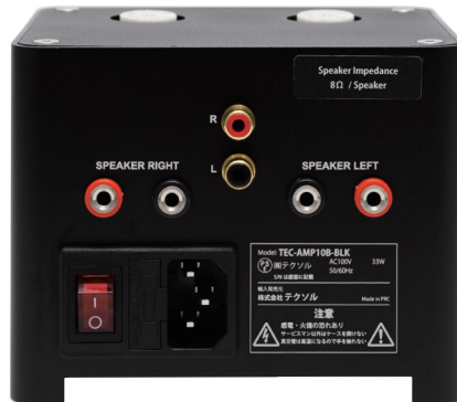
入力は RCA ジャック (2ch)1 系統。 出力端子はバナナプラグ専用となっています。
